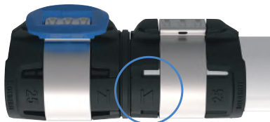
Rysunek 4: Gdy głębokość wsunięcia jest prawidłowa, rura jest widoczna we obu okienkach kontrolnych.
