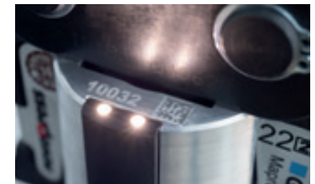
↑ Zintegrowane oświetlenie szczęk zaciskowych w urządzeniach Geberit ACO 103plus, ECO 203 i ACO 203XLplus zapewnia dobrą widoczność w ciemnych narożnikach.
