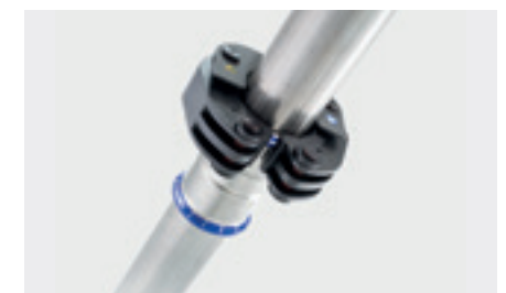
↑ Opaski zaciskowe są stosowane od średnicy 63 mm dla Geberit Mepla i od średnicy 42 mm dla Geberit Mapress.
