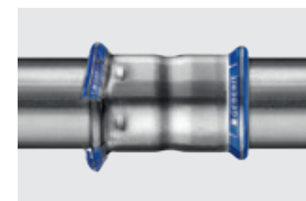
Kolorowe wskaźniki jeszcze przed próbą ciśnieniową pokazują niezaciśnięte złączki Mapress.
