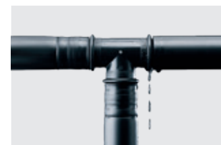
Zdefiniowane drogi wycieku sprawiają, że niezaciśnięte złączki są natychmiast widoczne w próbie ciśnieniowej.
